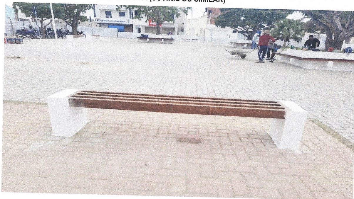
FOTO 28 - PINTURA DE ACABAMENTO COM LIXAMENTO E APLICAÇÃO DE 02 DEMÃOS DE ESMALTE SINTÉTICO BRILHANTE SOBRE MADEIRA (SUVINIL OU SIMILAR)
